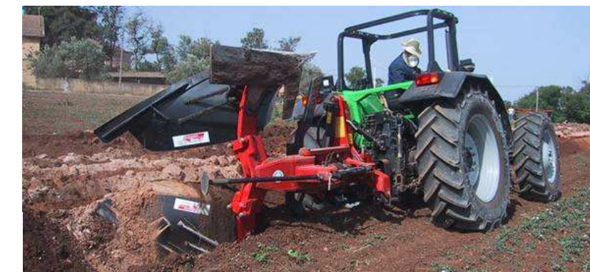
Défoncement d'un sol pour implanter une vigne
